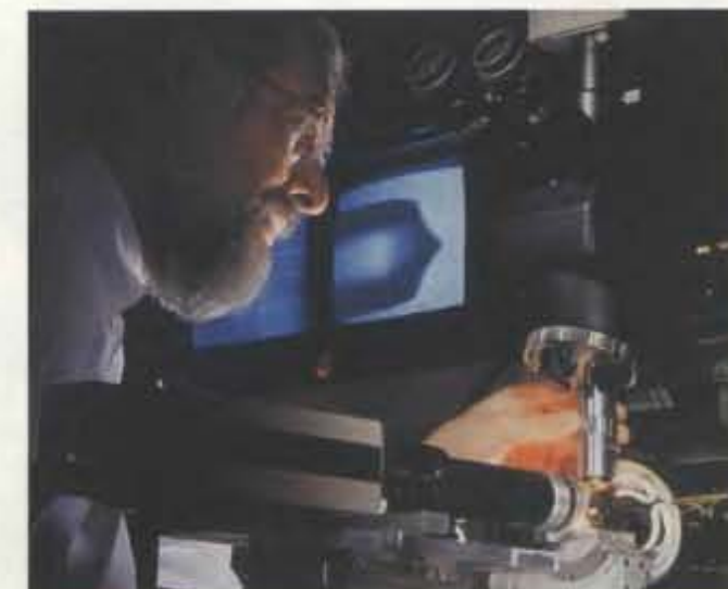
АСФЕРИЧЕСКИЙ ТОРЕЦ (спроектирован на экран) на кончике кварцевого световода был придуман сотрудником фирмы AT&T Германом Пресби.
